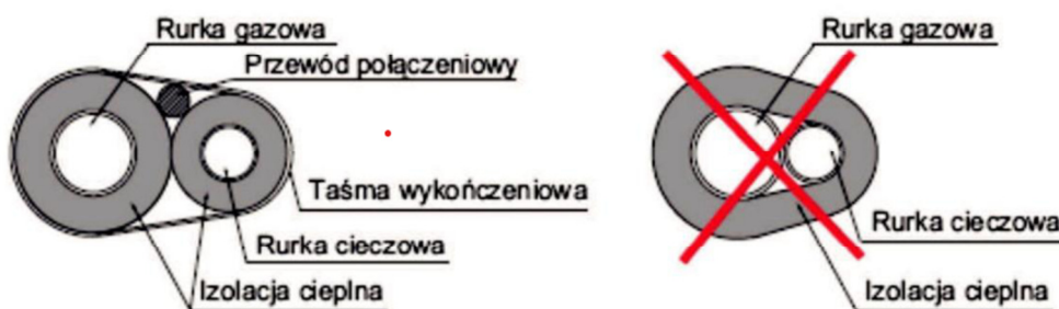
Rysunek 1. Sposób izolowania rurociągów
